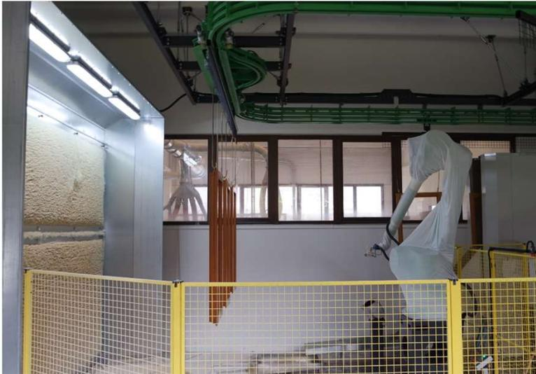
La peinture liquide est déposée soit manuellement, soit automatiquement. L'épaisseur de cette couche de peinture est en moyenne de 30  $\mu\text{m}$ .
