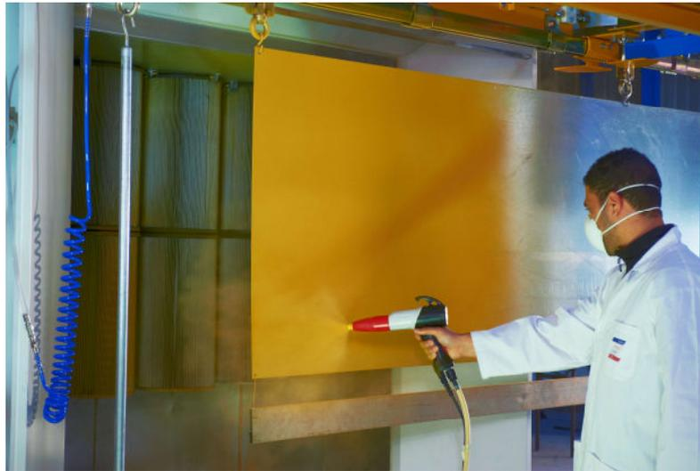
La poudre est déposée par un procédé électrostatique, soit manuellement, soit automatiquement. L'épaisseur de cette couche de poudre est en moyenne de 60  $\mu\text{m}$ .
